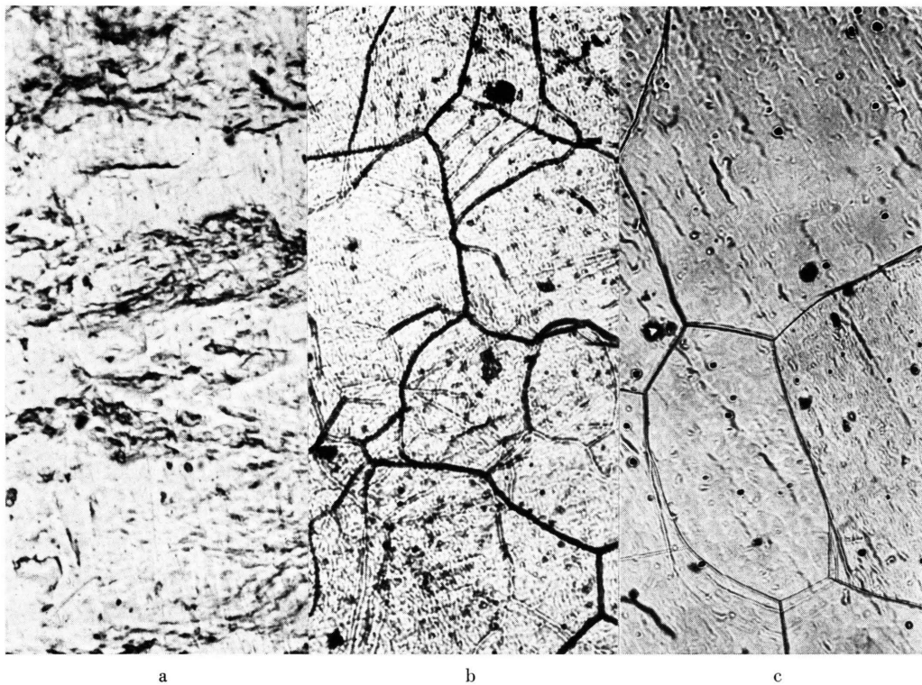
Abb. 2. Mikroskopische Aufnahmen der Oberfläche einer nicht vorbehandelten (a), einer im UHV ausgeheizten (b) und einer im UHV ausgeheizten und mit Pd bedampften Ta-Folie (c).
